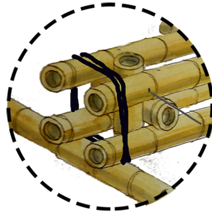
Fig. 2.9. Unión de las piezas de la columna
