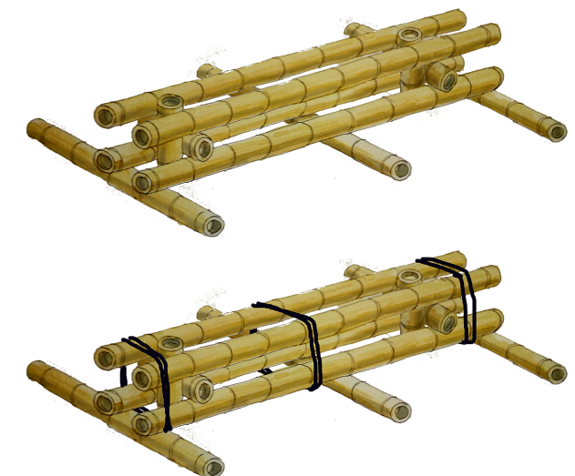
Fig. 2.8. Configuración y amarre de columna
